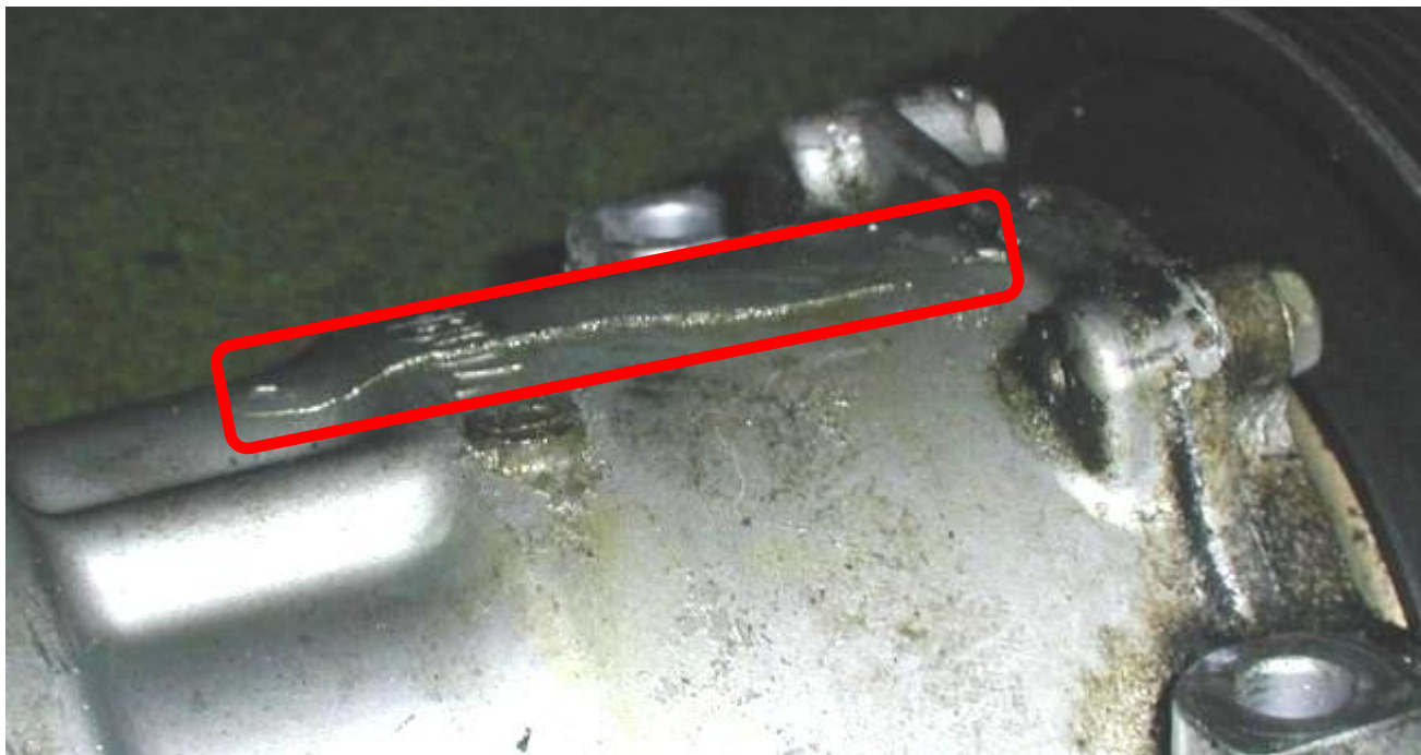
Prasknutý obal kompresora
